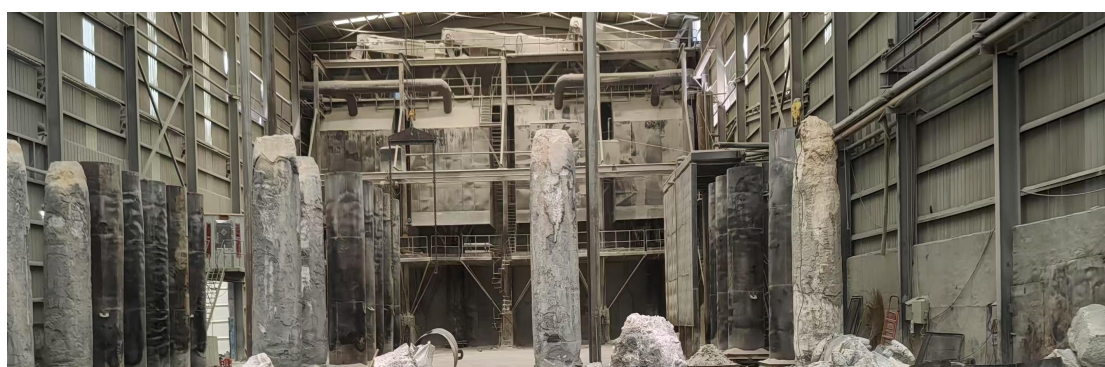
图五 电弧炉及烧成后正在自燃冷却的电熔镁
