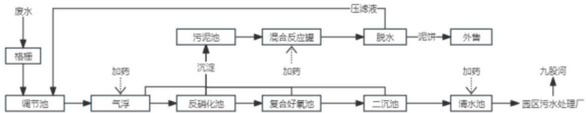
图6 污水处理工艺图
