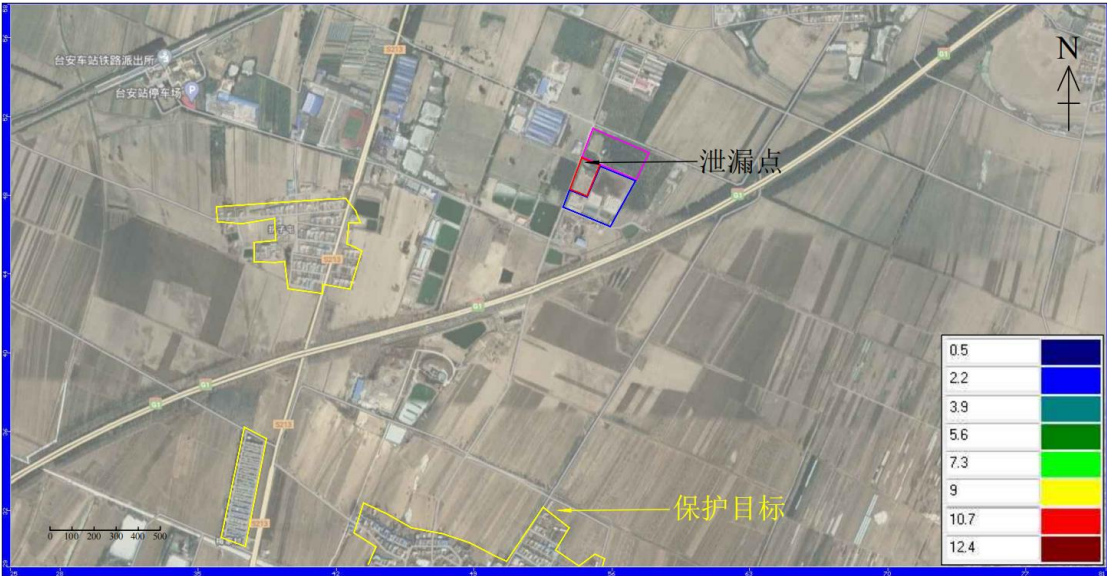
图 5.2-69 渗漏 365 天污染影响范围（氨氮）
