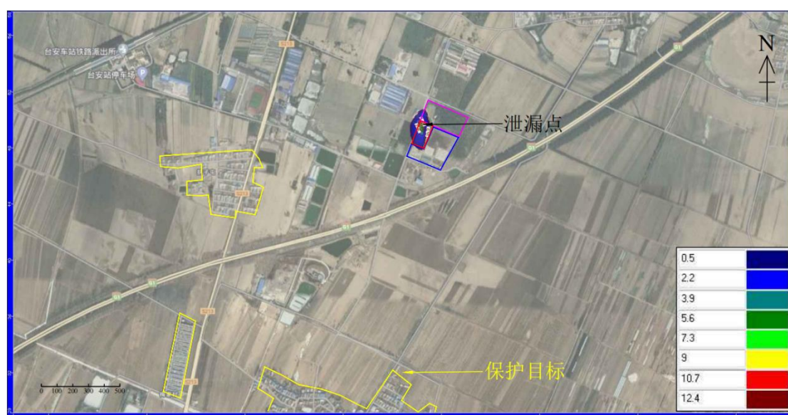
图 5.2-63 渗漏 10 天污染影响范围（氨氮）
