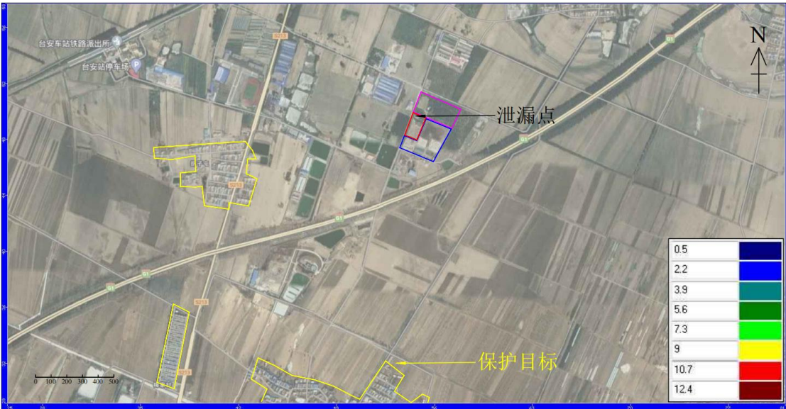
图 5.2-70 渗漏 1000 天污染影响范围（氨氮）
