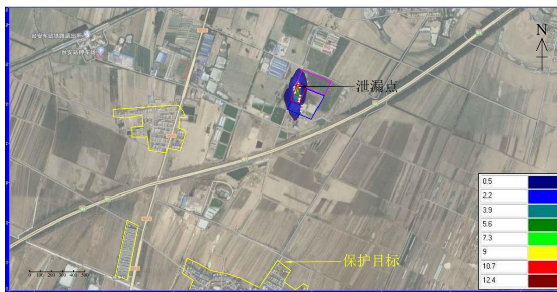
图 5.2-64 渗漏 30 天污染影响范围（氨氮）
