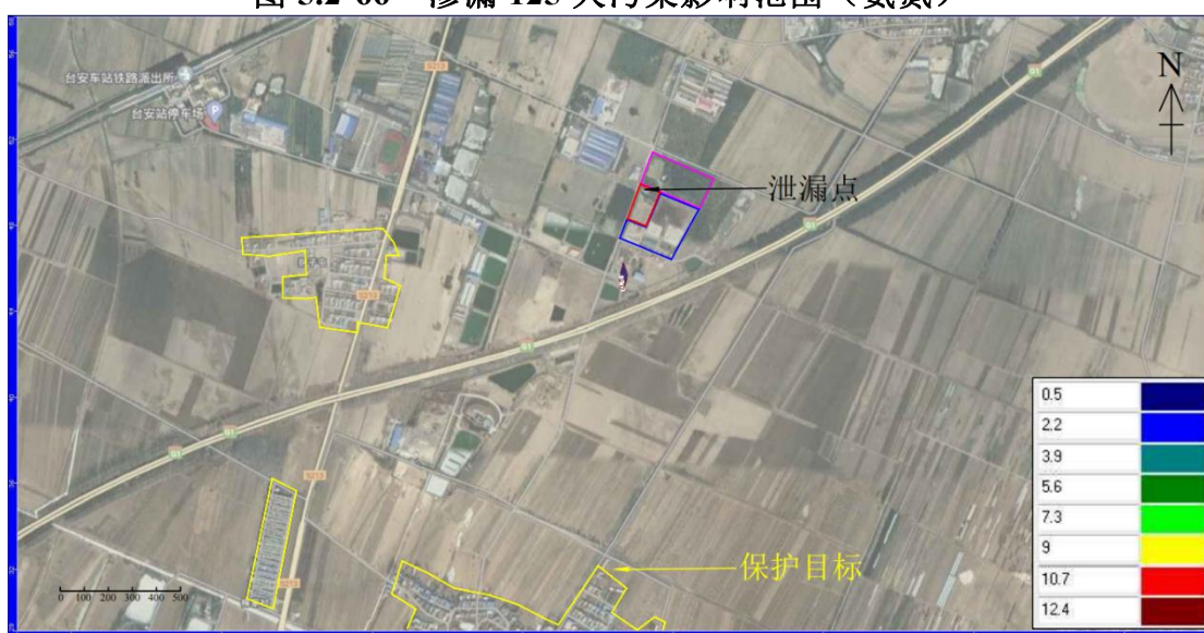
图 5.2-67 渗漏 139 天污染影响范围（氨氮）
