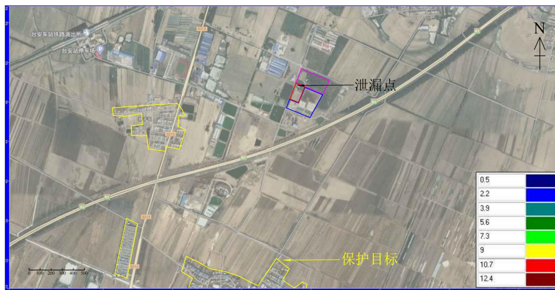
图 5.2-71 渗漏 3650 天污染影响范围（氨氮）
