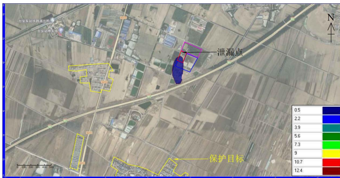
图 5.2-65 渗漏 100 天污染影响范围（氨氮）
