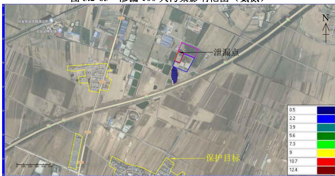
图 5.2-66 渗漏 125 天污染影响范围（氨氮）
