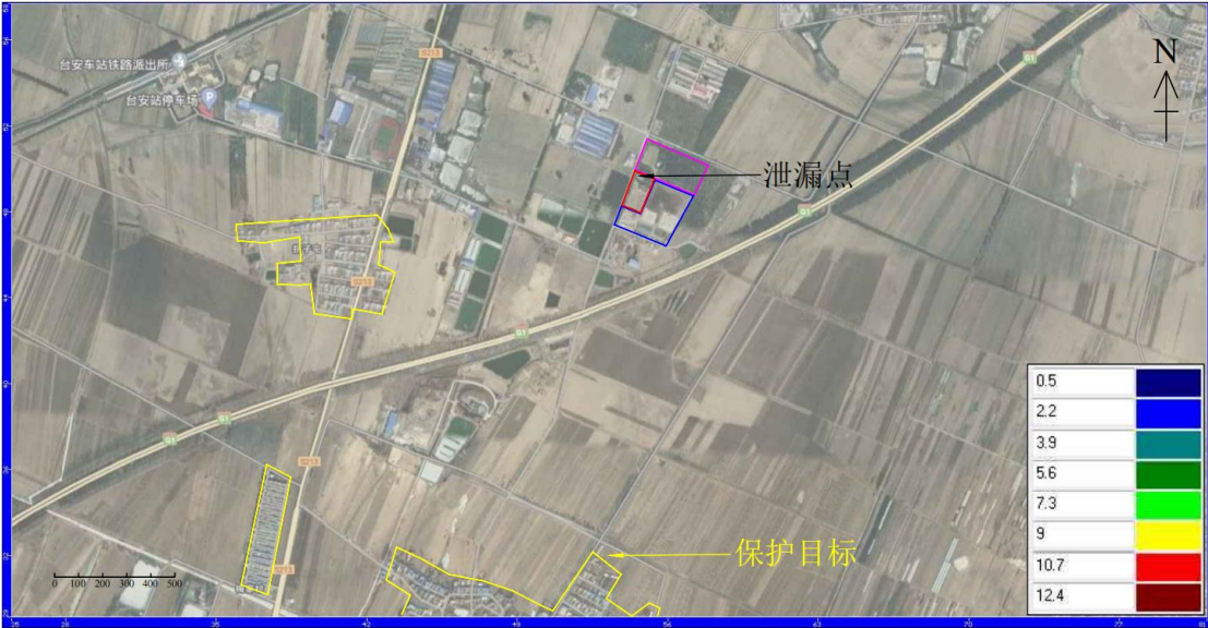
图 5.2-68 渗漏 142 天污染影响范围（氨氮）
