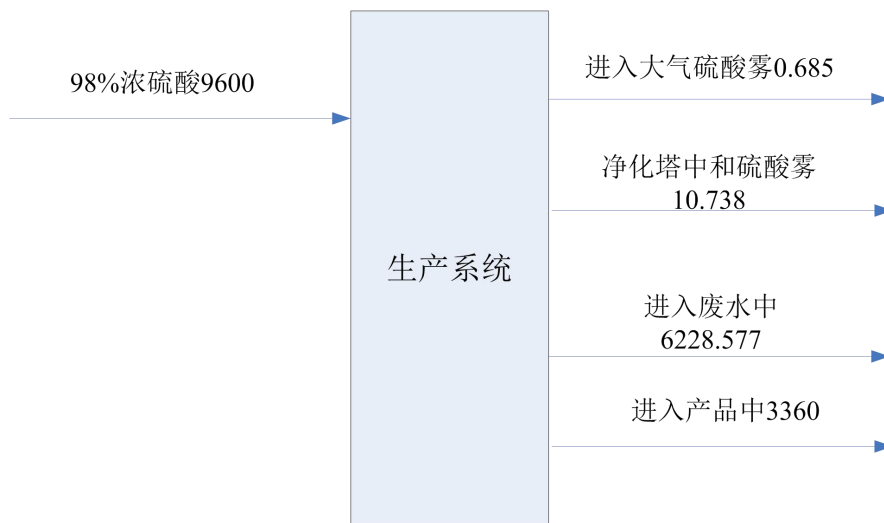
图8 本项目硫酸平衡图 单位 t/a
