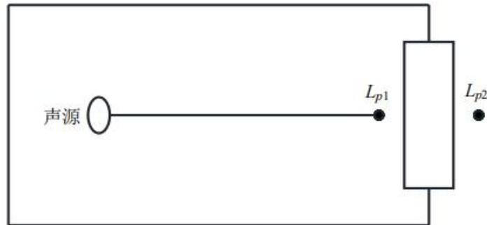
图4-3 室内声源等效为室外声源源图例
