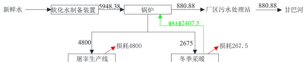
图 2-1 现有项目锅炉水平衡图 (t/a)
