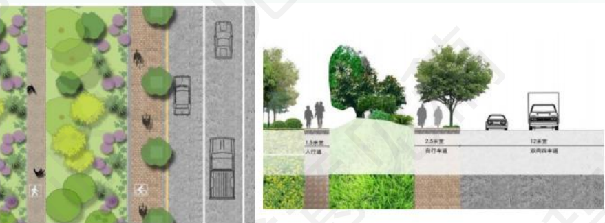
步行道和骑行道分离断面示意图
