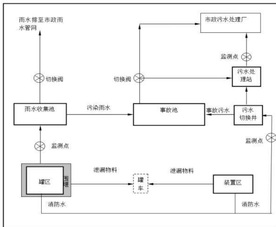
图 5.10-1 事故废水三级防控系统示意图
