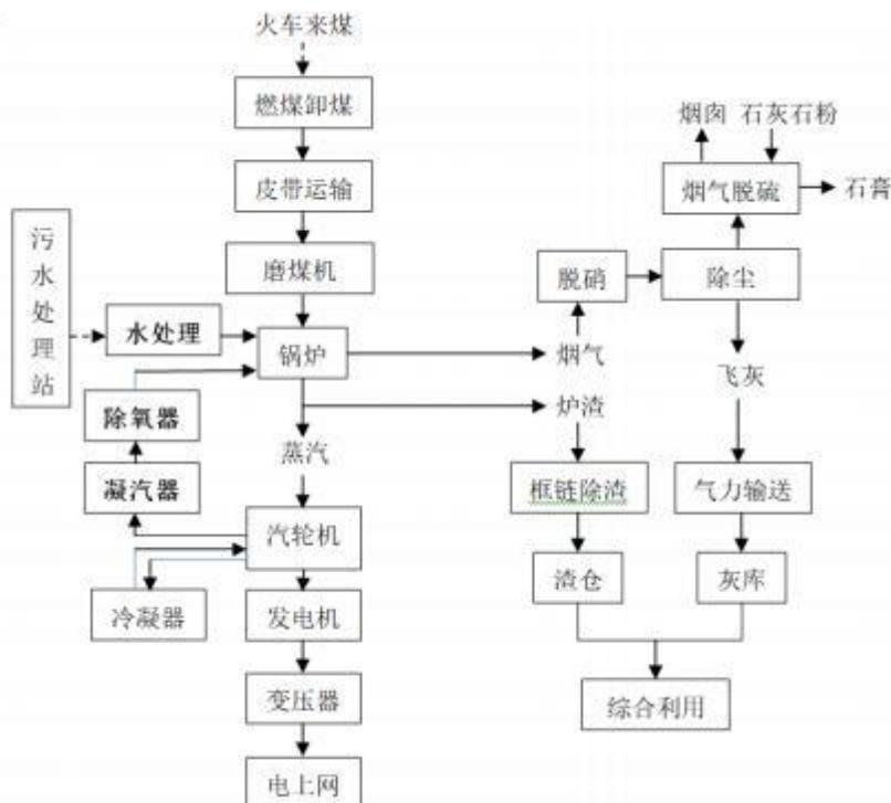
图 5.1-1 热电厂生产工艺流程图
