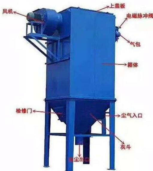
图 6.1-2 布袋除尘器结构图
