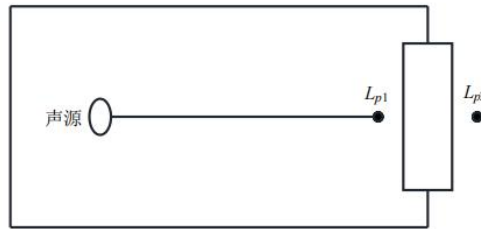
图 4-1 室内声源等效为室外声源图例
