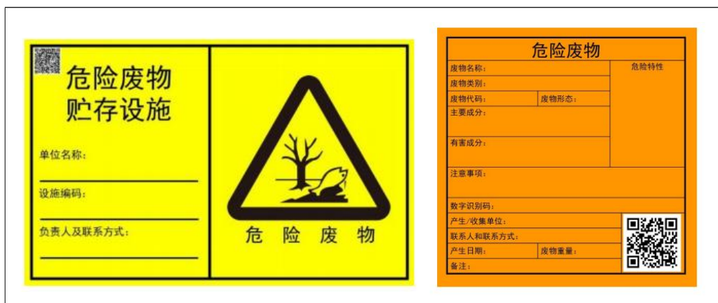
图 9-2 危险废物贮存设施标识及危险废物标签
