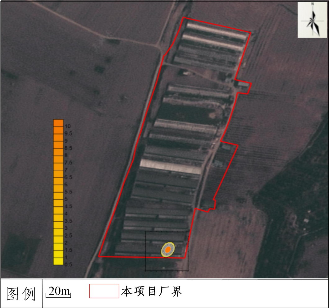
图4.2-18 污水处理站泄漏100d对耗氧量的影响预测结果图
