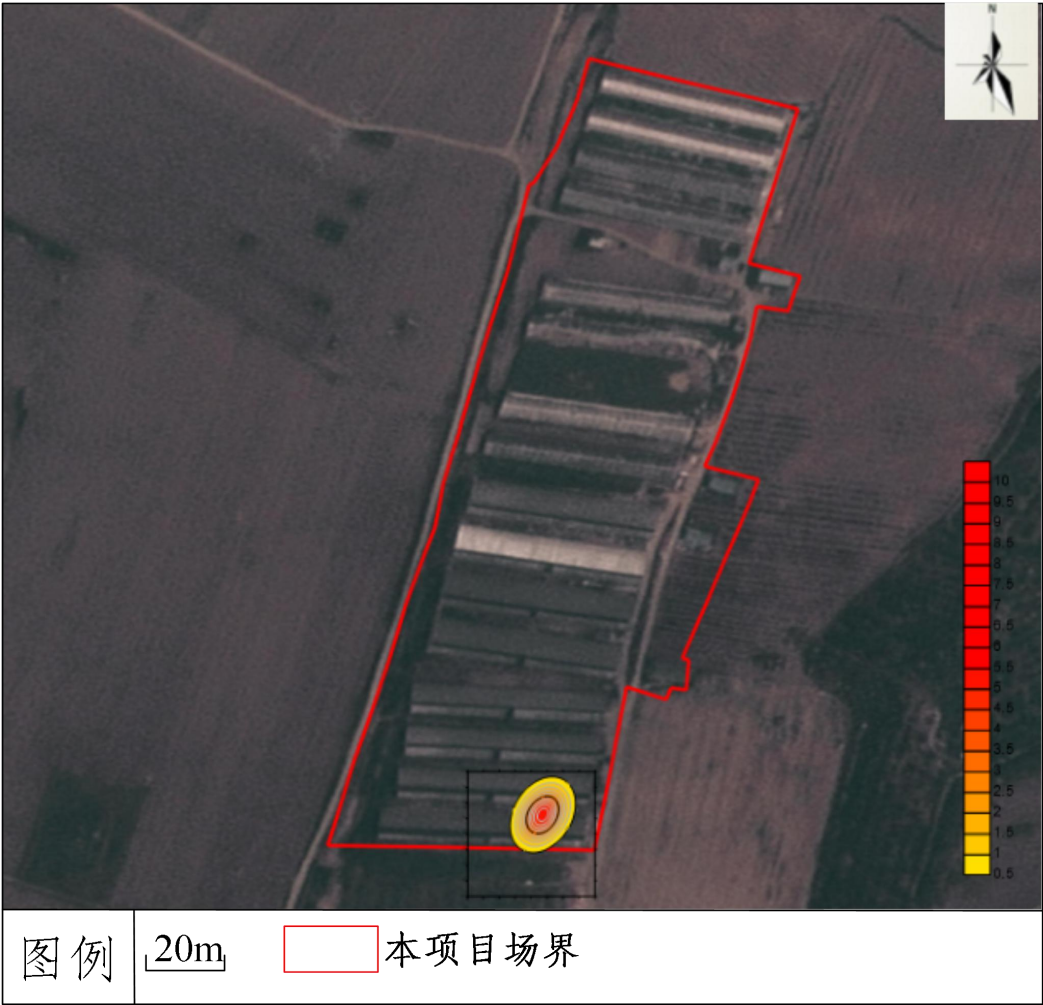
图4.2-19 污水处理站泄漏1000d对耗氧量的影响预测结果图
