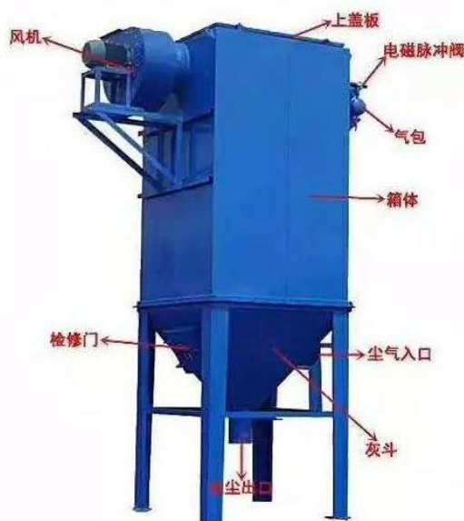
图 6.2-3 布袋除尘器结构图
