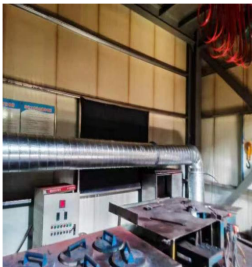
生产车间空压机设备封闭及安装隔音棉
