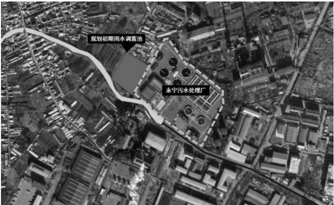
图 2-4 永宁污水处理厂新建雨水调节池方案
