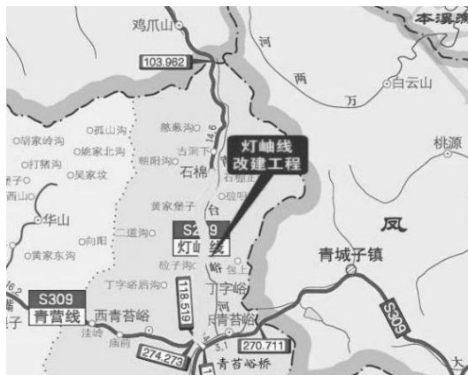
图 17 灯岫线升级改造工程。规划建设公路隧道，并实施路面改扩建。
