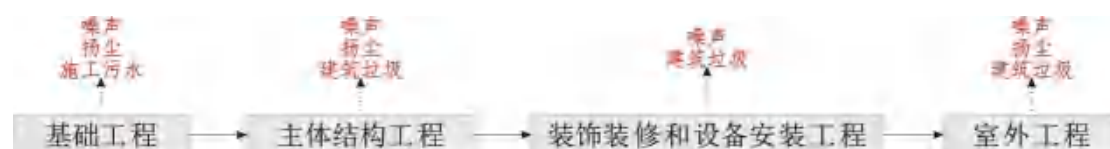
图 4.10-1 项目施工期工艺流程及产污节点图
