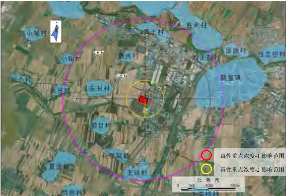
图 8.6-4 F 类稳定度下火灾爆炸事故一氧化碳浓度超过阈值最大轮廓线图
