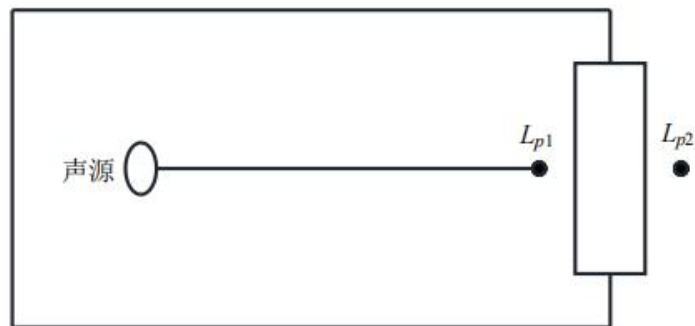
图 4-1 室内声源等效为室外声源图例
